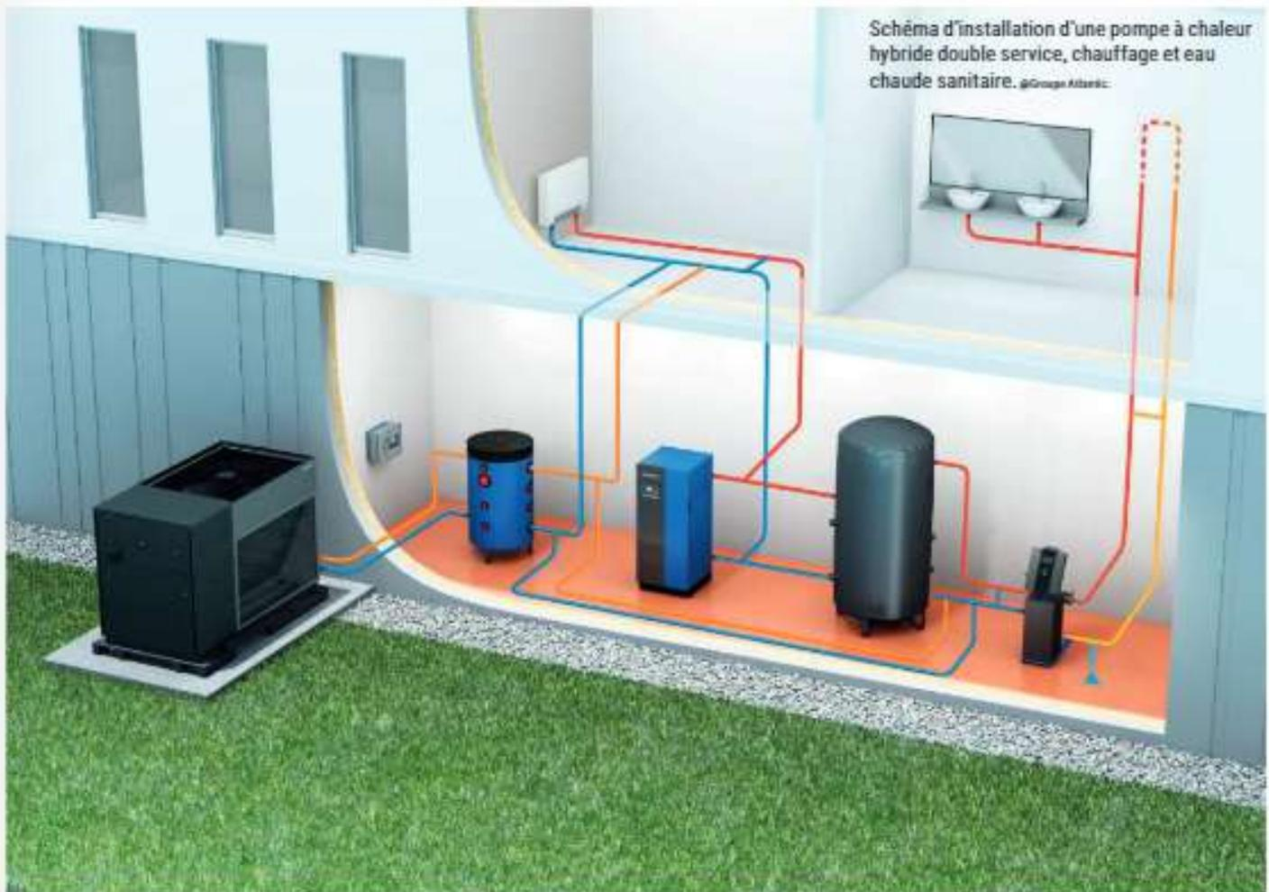
Schéma d'installation d'une pompe à chaleur hybride double service, chauffage et eau chaude sanitaire. ©Groupe Atteric.
